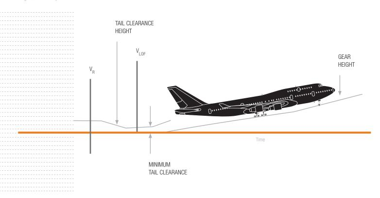
TYPICAL TAIL CLEARANCE FOR ENGINES-OUT TAKEOFF
